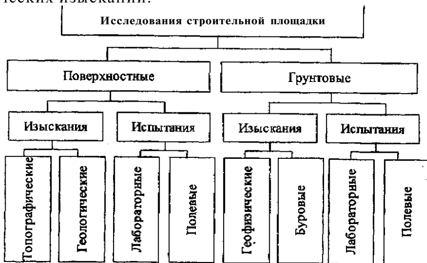
Рис. 2.6. Схема видов работ, выполняемых при инженерно-геологических изысканиях
