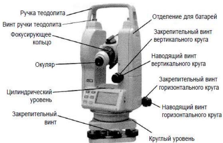
Рис. 7. Передняя сторона электронного теодолита VEGA TEO-5
